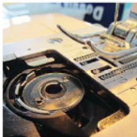
Některé modely mají cívkou spodní nitě uloženou horizontálně.
